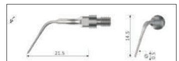
srPE2 CURVO A DESTRA, PER LA PULIZIA DELLE RADICI IN TASCHE GENGIVALI PROFONDE NELLA REGIONE POSTERIORE.
